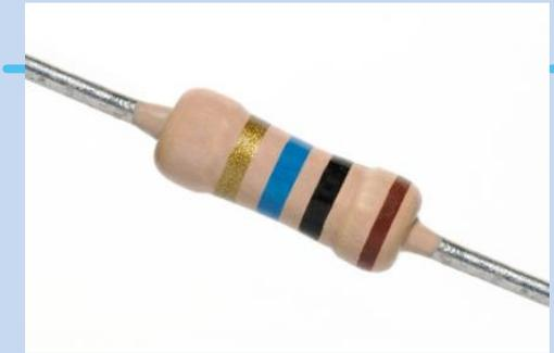
Der Wert eines Widerstands wird über farbige Ringe angegeben:
